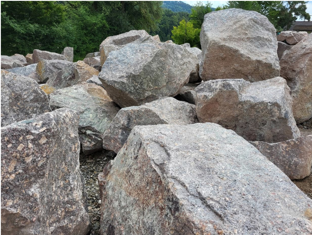
Abb. 5 Beispiel für formwilde Blocksteine [KWE]
