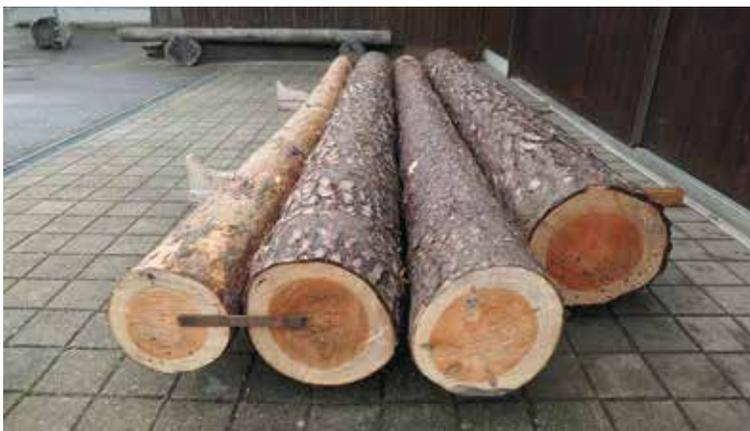
Das gesicherte Holzlager vor der Gattersagi zeigt vier unterschiedliche Trämmel vom gleichen Stamm. Rechts liegt der untere dickste Teil, dann die mittleren und links das oberste Stück mit dem schwächsten Durchmesser. Gut sichtbar sind die gleichmässigen Jahrringe und der Farbunterschied von Kern-(rot) und Splintholz (hell).
