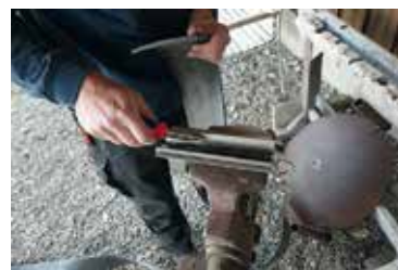
Peter Baumann hat den defekten Riemen abgeschnitten und presst im Schraubstock mit Hilfe des Werkzeugs das neue Riemenschloss in das Riemenende
