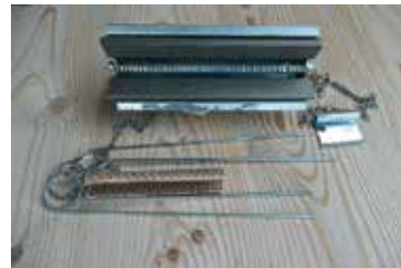
Werkzeug für die Montage von Riemenschlössern mit einem neuen Schloss und Metallstiften
