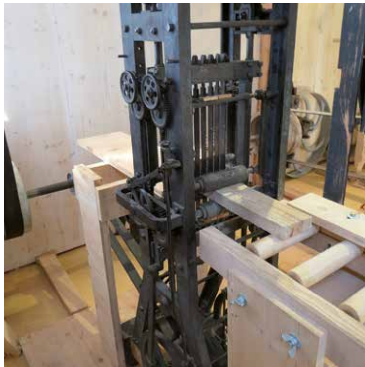
Die kleine Gattersäge aus Hüntwangen, die in der Literatur um 1880 als Kurzholzgatter für Kistenfabriken beschrieben wird. Fotos: Otto Weilenmann
