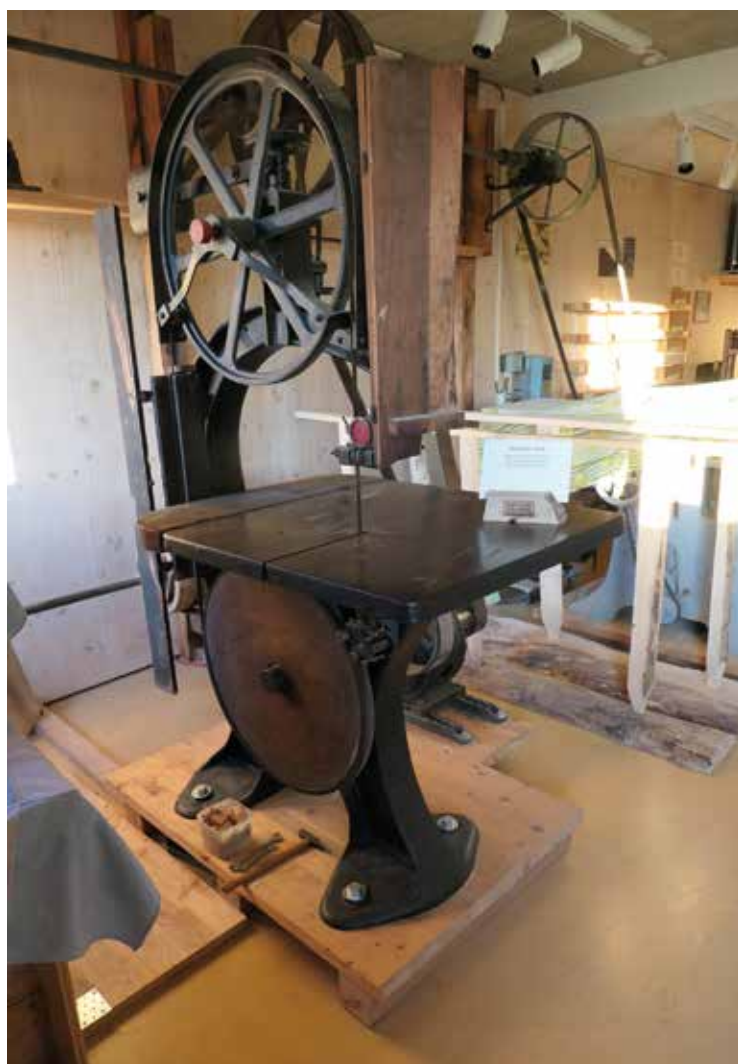
Antike Bandsäge aus der Käferei von Emil Simmler sen., angetrieben durch die Transmission in der Gattersagi
