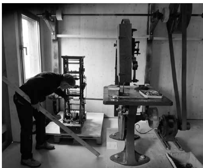
Robert Kern beim Installieren der kleinen Gattersagi aus Hüntwangen, daneben die Bandsäge mit Motor und die Transmission an der Wand
