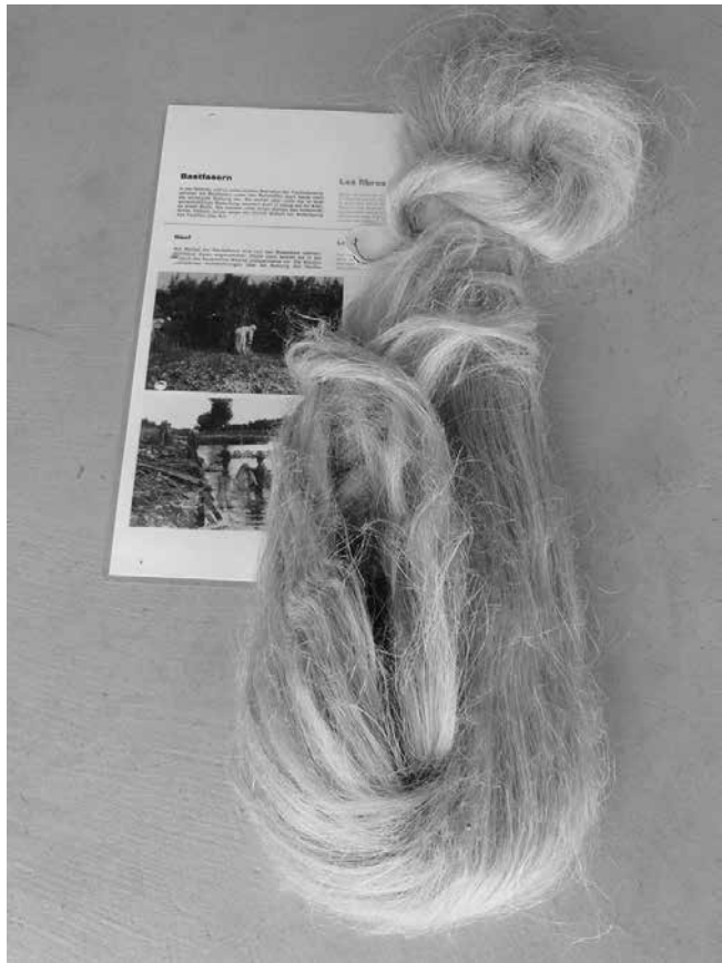
Saubere Hanffasern, bereit zum Spinnen oder zum Abdichten von Wasserleitungen
