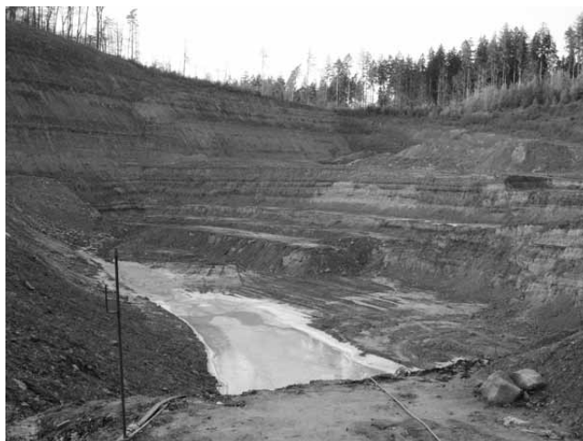
Lehmgrube der Zürcher Ziegeleien ZZ WANCOR, Rafz mit den 35 Meter hohen Wänden mit idealem Lehm für die Herstellung von Backsteinen
