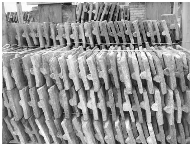
Palette mit zum Decken vorbereiteten ur-alten Biberschwanzziegeln
